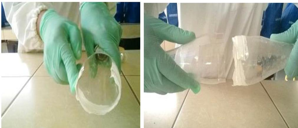
**Figura 4.** Unión de las dos mitades de dos botellas para formar un compartimento.
