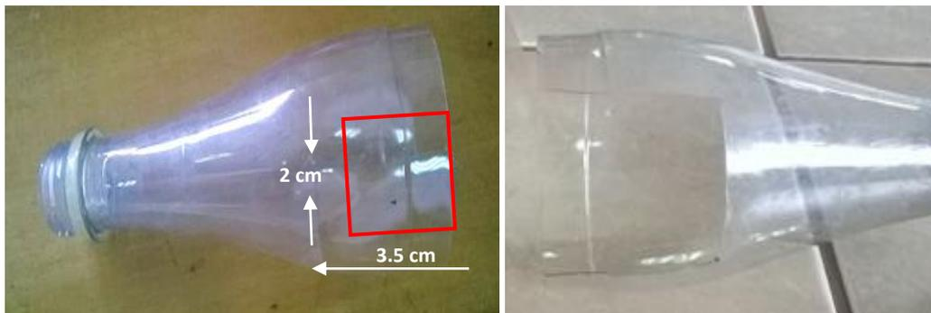
*Figura 3. Mitad de un compartimento indicando el corte para la apertura superior.*
