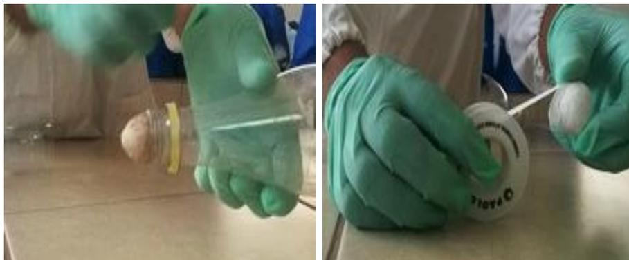
*Figura 9. Tapón y procedimiento de envoltura con teflón.*
